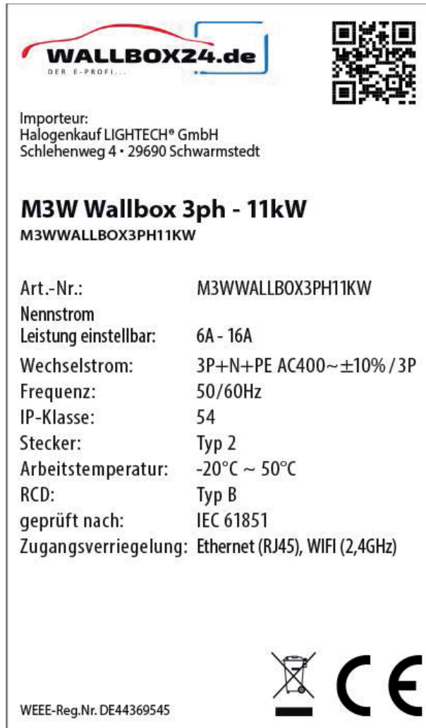
Abb. 3-5 Typenschild der Ladestation
