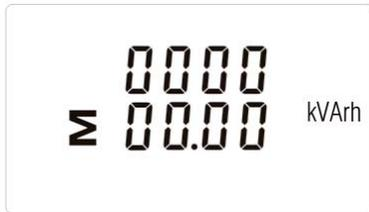
Hier wird die Gesamt-Blindleistung [kVArh] angezeigt.
