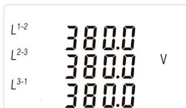
Hier werden die aktuellen Spannungen [V] zwischen den Phasen und dem Neutraleiter (3p3w) angezeigt.
