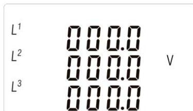
Hier werden die aktuellen Spannungen [V] zwischen den Phasen und dem Neutraleiter (3p4w) angezeigt.
