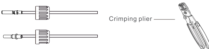
Abb. 5.4 Crimpen des Kontaktstifts an den Draht
